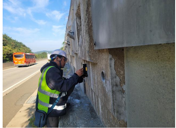
경사계를 이용한 경사도 측정사진
